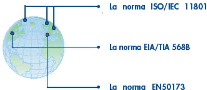
Le normative EIA/TIA sono state le prime normative circa il cablaggio strutturato; per questo motivo, pur essendo americane, sono state e continuano ad essere utilizzate anche in altri paesi.
