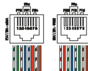
Rappresentazione della disposizione delle coppie sui pin frontali della presa, nelle due tipologie di cablaggio.
