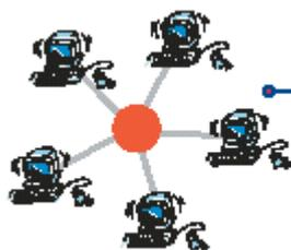
La tipologia di un cablaggio LAN si sviluppa generalmente **a stella**: questa soluzione prevede molti collegamenti punto punto connessi all'apparato centrale (hub, switch). In queste reti è possibile aggiungere o rimuovere i dispositivi senza condizionare la funzionalità della rete, riducendo i costi per la stesura delle linee.
